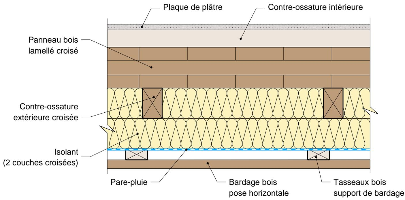
**MUR EXTERIEUR TYPE 9: Mur panneau bois lamellé croisé avec isolant extérieur**
